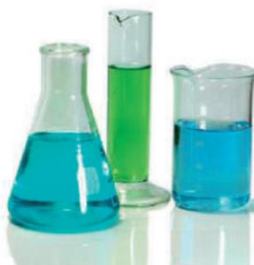
Matr az, probeta y vaso precipitado
